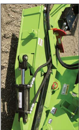
Hydraulické ovládání oje ( na přání )
