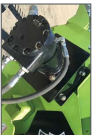
Příčný pohon rotoru hydromotorem přes spojku eliminuje rázy.
