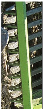
Robustní rošt a podávací rotor je vyroben z extra odolné oceli 450 BHN
