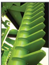
Extra odolný rošt a robustní ramena podávacího rotoru 450 BNH s vyměnnými prsty
